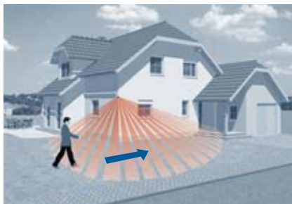
Détection tangentielle – mouvement en travers du détecteur (portée nominale)
