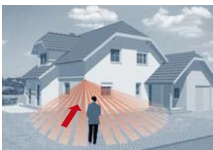
Détection radiale – mouvement direct par rapport au détecteur (détection réduite par rapport à la portée nominale)
